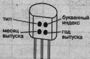
Рис. 2.4. Места цветовой маркировки транзистора КТ3107 в корпусе КТ-26 (ТО92)
